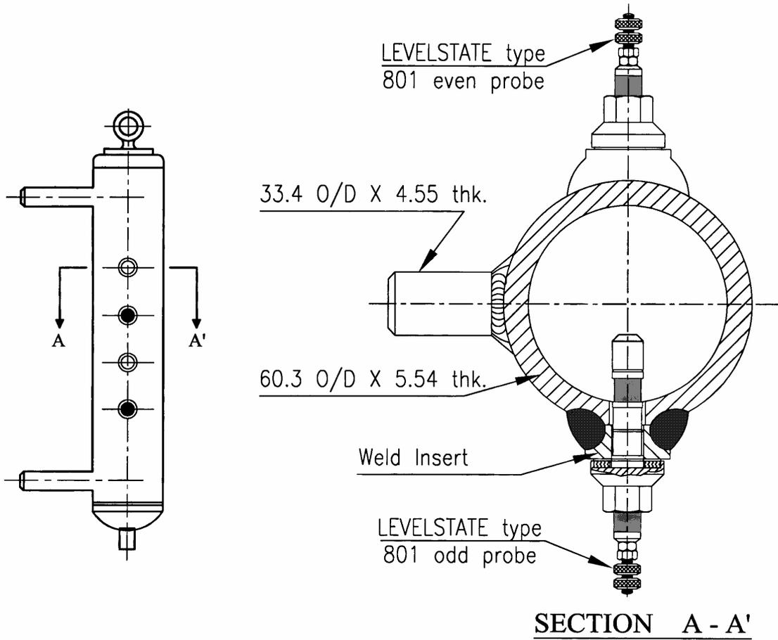
**Fig. 3.1 Stand Pipe Assembly**
